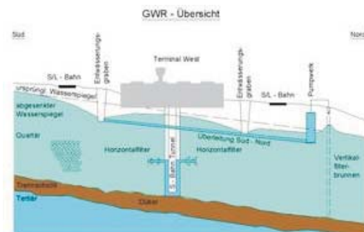
Abbildung: Grundwassermesstechnik - Quelle Flughafen München
