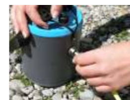
Anschluss der steckbaren Multiparametersonde MPS
