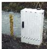
Schutzgehäuse mit Punckantenne
